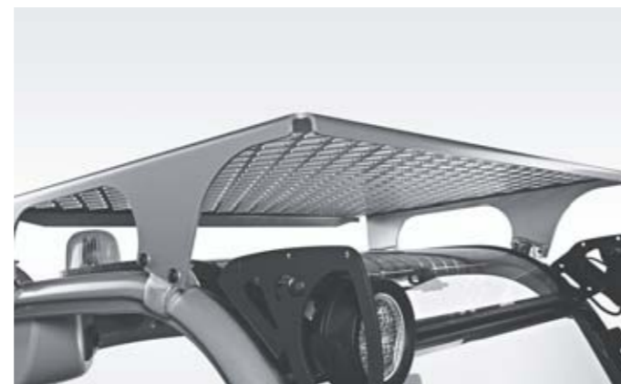
Protezione supplementare stabile dalle unità di carico a rischio caduta
